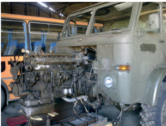
Zdemontowany silnik z pozyskanego stara 266 przygotowany do wymiany w wozie strażackim
